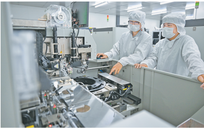
10月18日,工作人员在海南航空高科技产业园芯片封装测试车间内安装调试贴片机。 海南自贸港自封关运作以来,依托“双15%”税收优惠、零关税进口设备等政策红利,加速填补半导体封测产业空白。海南自贸港正将制度优势转化为产业动能,打造芯片出海枢纽,跑出高新技术发展的“芯”动能。 新华社记者 郭程 摄
