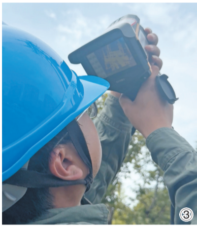
图①:休息间隙摘帽擦汗。 图②:电网巡检员使用仪器检查线路温度。 图③:查看仪器上显示的线路温度。 图④:巡检工作中核对线路。
