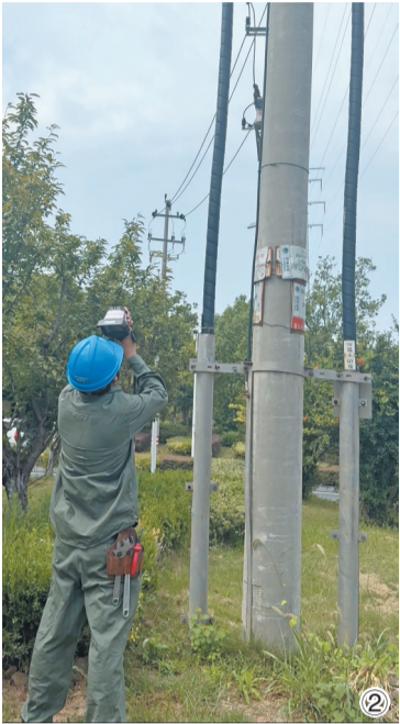
图①:休息间隙摘帽擦汗。 图②:电网巡检员使用仪器检查线路温度。 图③:查看仪器上显示的线路温度。 图④:巡检工作中核对线路。
