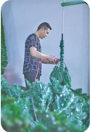
制作圣诞树需要经过多道工序,工人指尖翻飞将一束束仿真松针均匀绑扎在金属枝干上。
