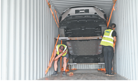
经过高温炙烤集装箱温度可以飙升至45摄氏度,工作人员进箱对汽车进行固定、绑扎。
