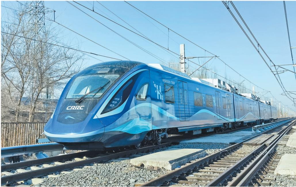
我国首列氢能市域列车在位于长春的中车长客试验线进行运行试验(2024年3月21日摄)。 新华社发
