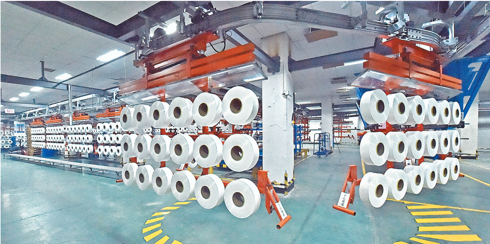
“华鼎锦纶”公司拥有从德国、日本、瑞士等国家引进的世界一流生产流水线。智能仓储系统、自动BRS输送系统、卷绕机日本TMT、自动落筒系统德国DTY自动化包装线等一系列智能设备投入使用,使空间利用合理化、生产自动化、管理简便化,生产效率大大提高。
